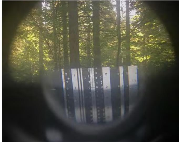
**Figura 2.** Foto del mirino interno del relascopio di Bitterlich. Banda n.1 a sinistra.
